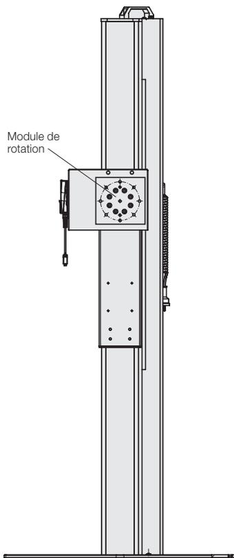
Module de rotation monté sur un module de levage avec module de chariot (disponible sur demande)
