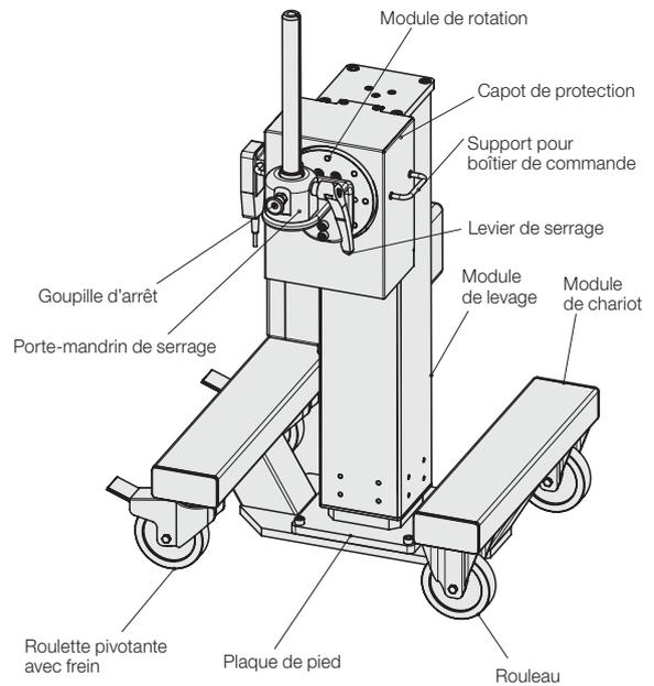
Module de rotation monté sur le module de levage Shop-Floor (disponible sur demande)
