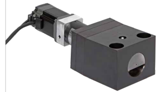
5.2670 Éléments de serrage par coin pour outils avec bord de serrage plat ou incliné autobloquant avec contrôle de position force d'actionnement maxi. 240 kN
