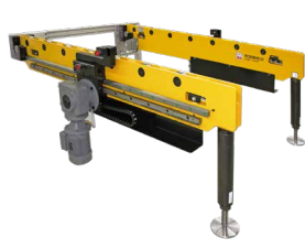
8.18353 accionamiento eléctrico con accionamiento por cremallera y piñón peso del troquel hasta 25 t
