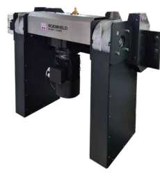
8.18362 Sistema directo de cadena de empuje con sistema Push-Pull con accionamiento eléctrico con accionamiento por cadena de empuje peso del troquel hasta 40 t
