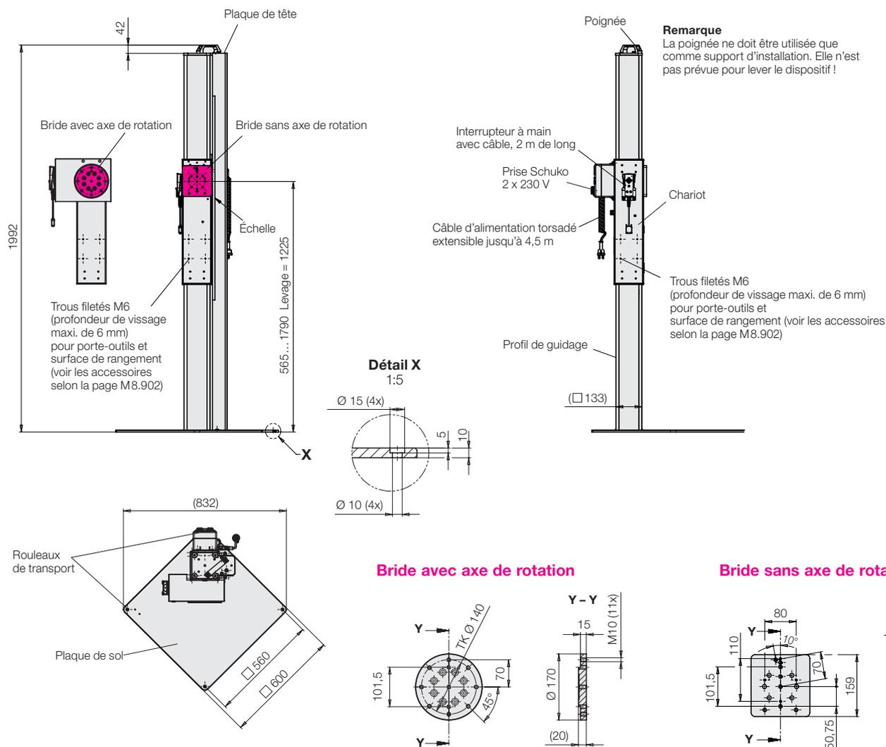
Avec taraudage pour le vissage du support de montage universel pour les griffes de serrage et le support à 3 points.
